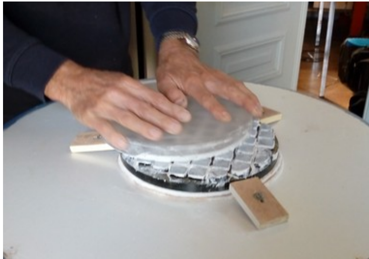
Fig 18 : courses de polissage en 'W'
