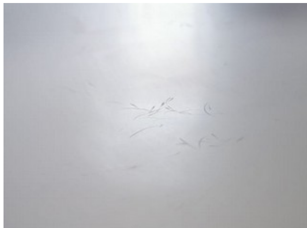
Fig 16 : rayures profondes dues à la présence d'un grain indésirable.
