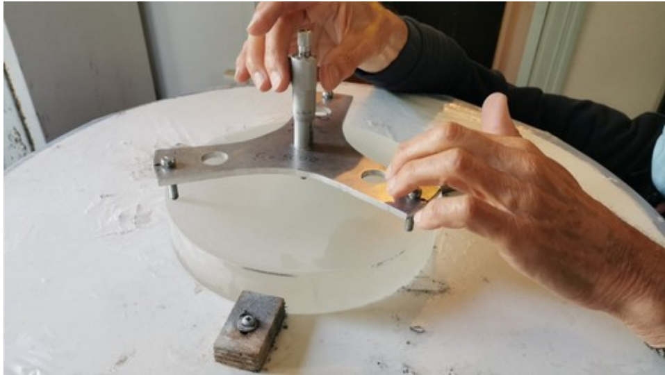
Fig 15 : notre sphéromètre à base de palmer
