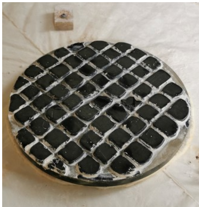
Fig 17 : notre polissoir, poix sur hublot de navire.
