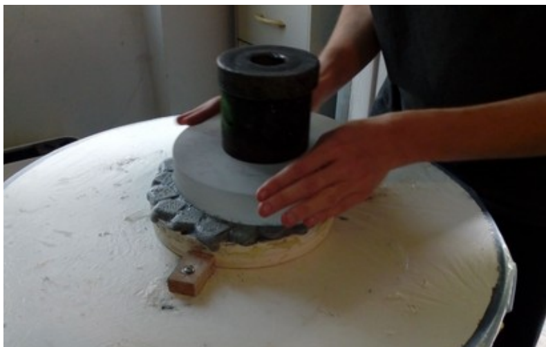
Fig 14 : courses d'ébauchage miroir dessus avec des poids pour aider.
