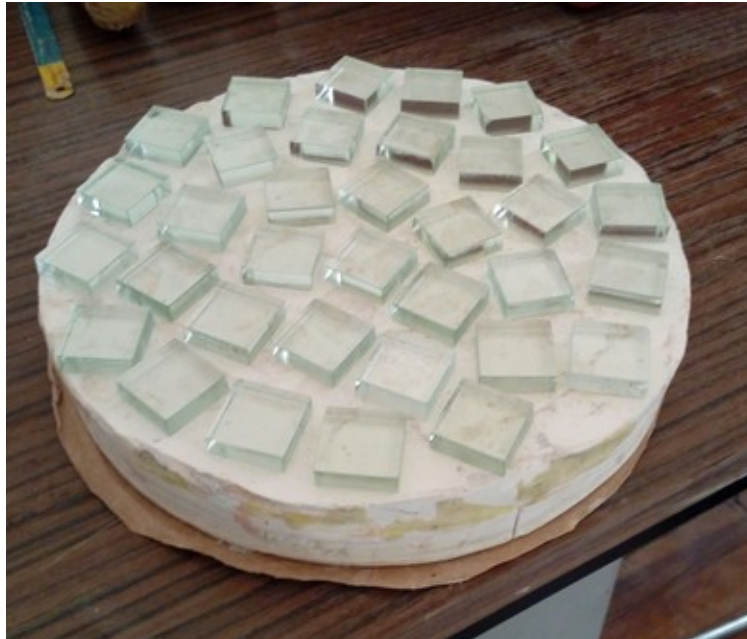
Fig 13 : outil segmenté en plâtre synthétique (Staturoc) avec ses carreaux de verres
