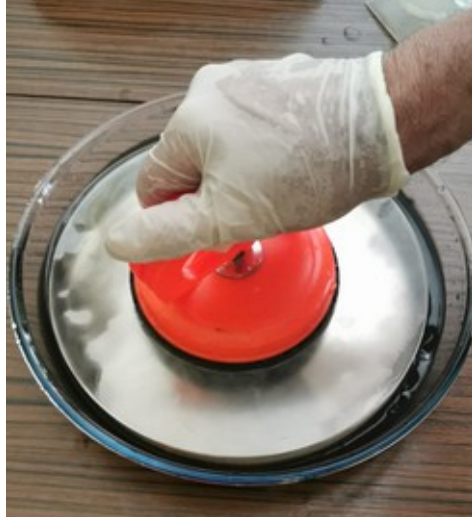
Fig 21 : argenture. Noter le précipité d'argent (noir)
