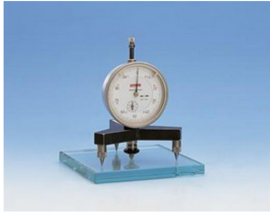
Figure 5 : exemple de sphéromètre à base de comparateur (univ. du Mans)
